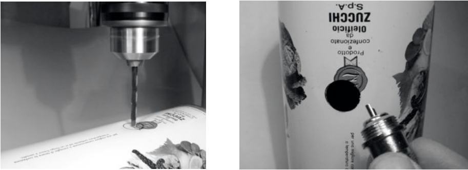
Figura 4.37: Taladre cuidadosamente un agujero piloto, luego use una mecha más grande para terminar el trabajo.
