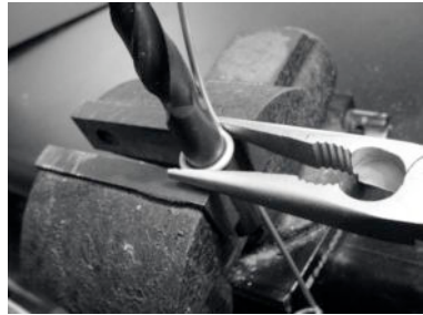
Figura 4.18: Curvar el alambre alrededor de un tubo para hacer un anillo.
