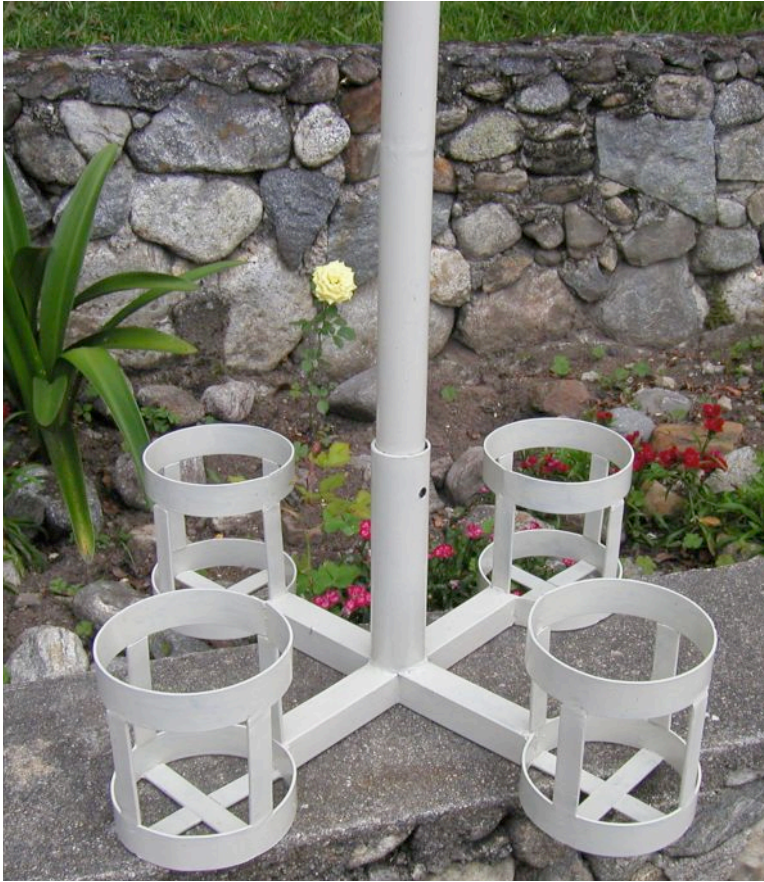
Figura 7.5: Esta base de metal puede cargarse con bolsas de arena, rocas o botellas de agua para lograr una plataforma estable sin penetrar el techo.
