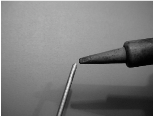
Figura 4.38: Estaño el extremo del alambre antes de soldarlo.
