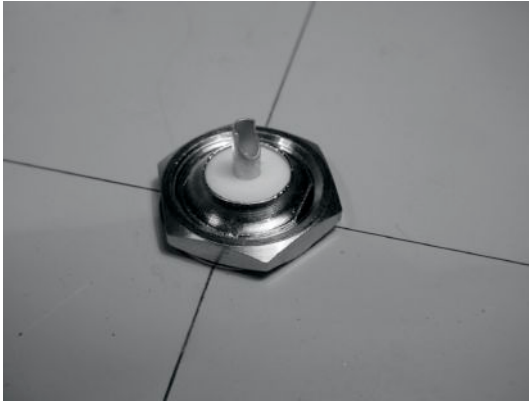
Figura 4.25: Asegure el conector N firmemente a la placa
