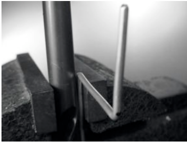
Figura 4.18: Curvar el alambre alrededor de un tubo para hacer un anillo.
