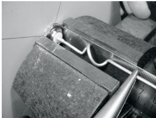
Figura 4.28: Estirar los anillos. Sea muy cuidadoso y trate de no raspar la superficie del alambre con las pinzas.
